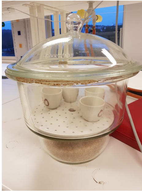
Bilde 25. Tørrstoff prøver står i Eksikator for nedkjøling
