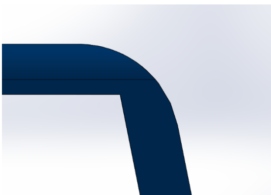
Figur 12 overgang, 5 cm avrunding på utsiden.
