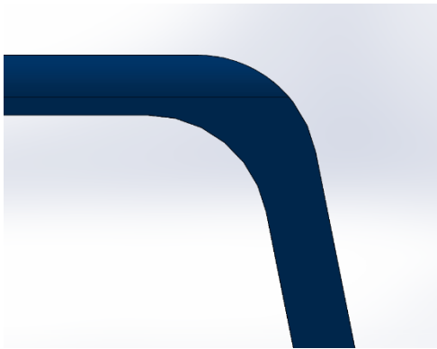
Figur 11 Overgang, 5 cm avrunding på innsiden og utsiden.
