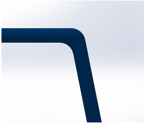
Figur 13 overgang, 2.5 cm avrunding på utsiden og innsiden.
