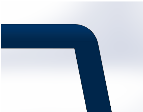
Figur 14 Overgang, 2.5 cm avrunding på utsiden.
