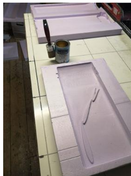
Figur 35: Lakkering av former
