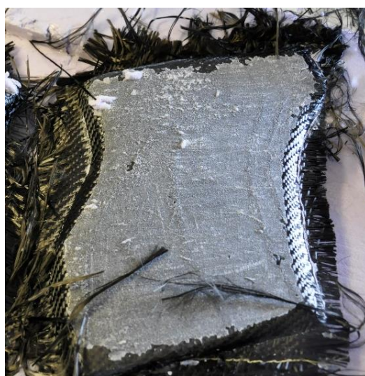
Figur 61: En av karbonfiberdelene med formmateriale og lakk hengende fast i overflaten
