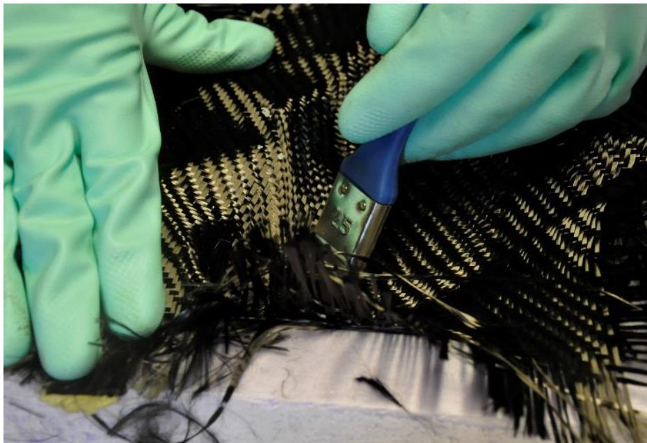
Figur 43: Pensling av epoksy på karbonfiberduken i støpeformen
