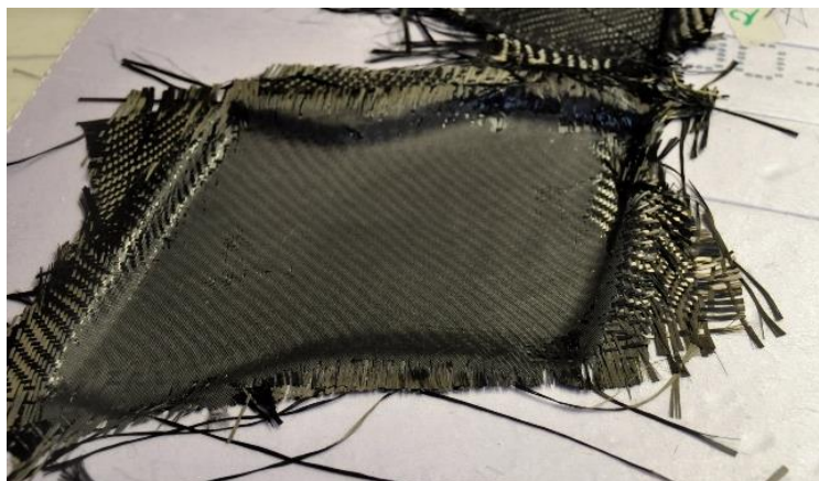
Figur 60: Ferdig herdet teststøp i støpeform
