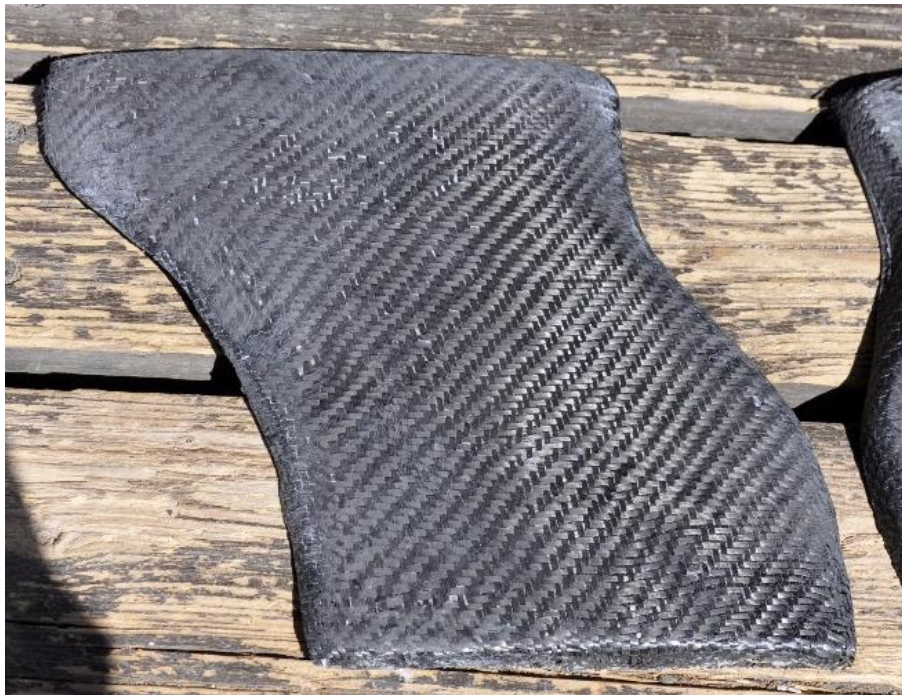
Figur 62: Endelig overflate på karbonfiber etter pussing
