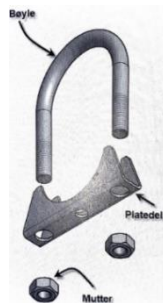
Figur 1 - 3D-modell av en eksosklemmer
