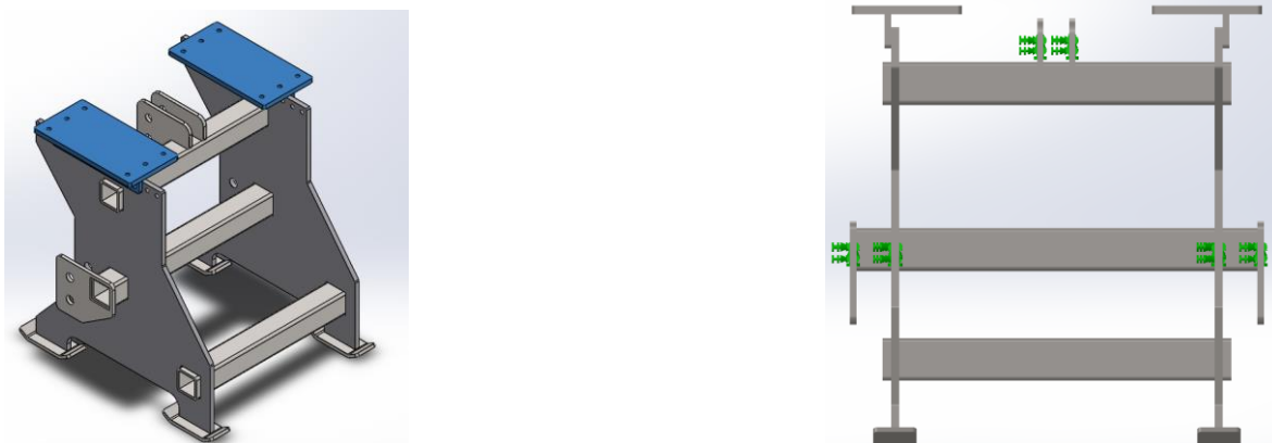
Figur 34 - Områder med opptrædende krefter, som krever lokal tilpasning
