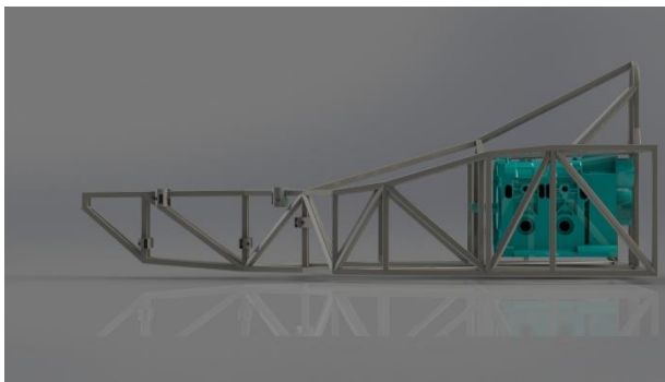
Figur 25: Viser 13B-REW plassert i ramme, sett fra siden
