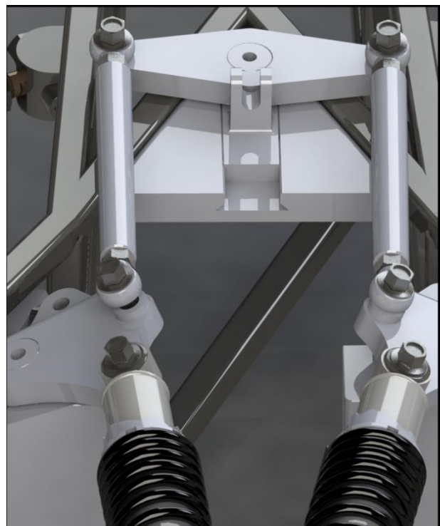
Figur 36: Sleide til stabilisatorstag, med smørekanaler for å minske friksjon
