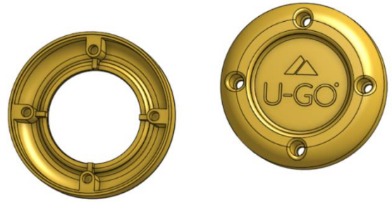
Figur 54 - Halvdeler med feil festemetode.
