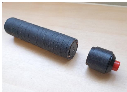
Figur 66 - Håndtak med vibrasjonsmodul og bryter.
