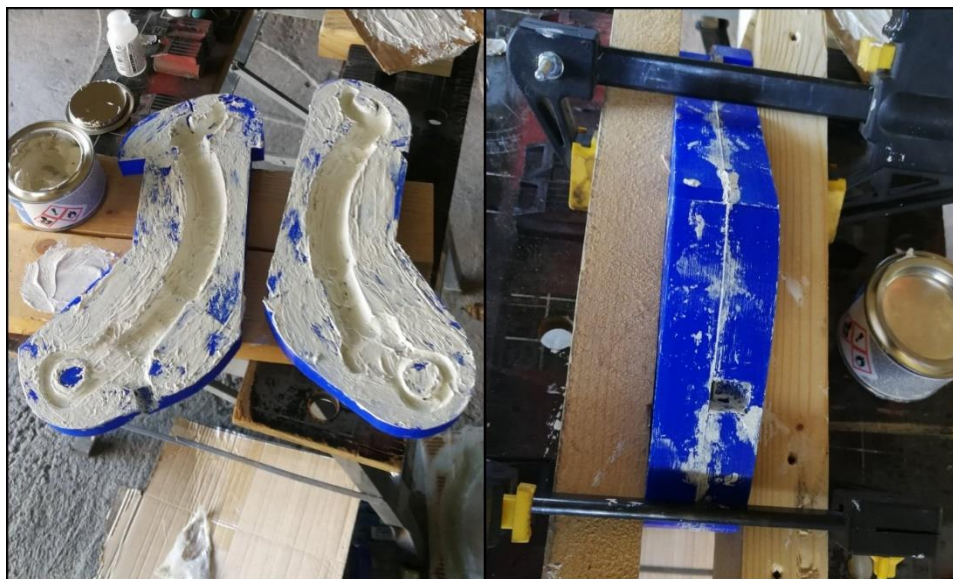
Figur 20 – Klargjøring for støping.
