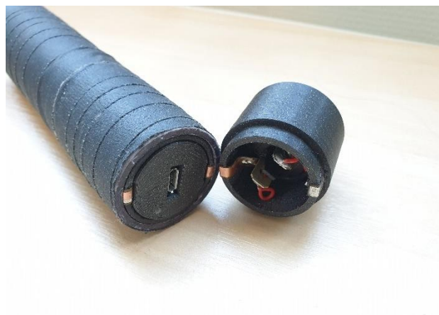
Figur 65 - Håndtak, vibrasjonsmodul og bryter.
