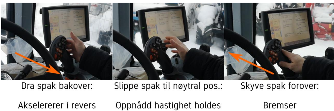
Figur 6: Hvordan man kjører bakover. Foto: Monika S. Bakkehaug
