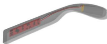
Figur 25: Alternativ 1 for komponenter med kretskort i fremre del av brillestangen og batteri i bakre del. Illustrasjon: Harald Thingbø
