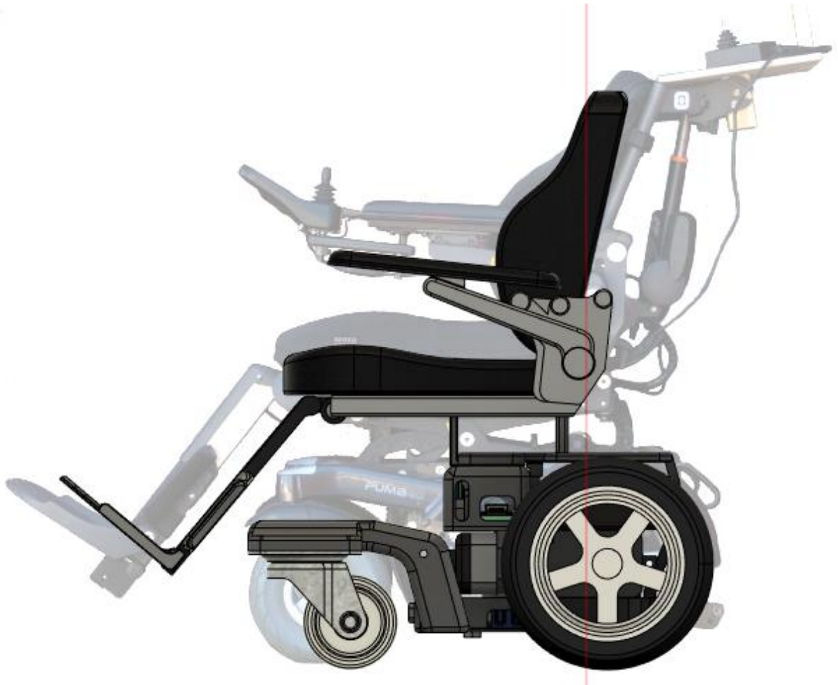
Figur 50: Setepute, ryggstøtte, fothviler, framhjul og armlene modelleres etter bilder av rullestolen.
