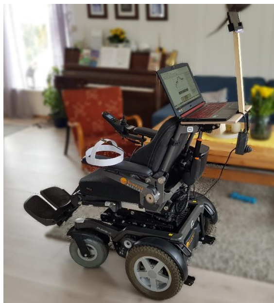
Figur 13: Mikrokontrolleren er festet til en papirbøyle som passer rundt testpersonenes hode. En PC er festet på en plate bak nakkestøtten for å logge dataene fra mikrokontrolleren. Et mobilkamera er festet på en stang over PC-en. Foto: Harald Thingbø
