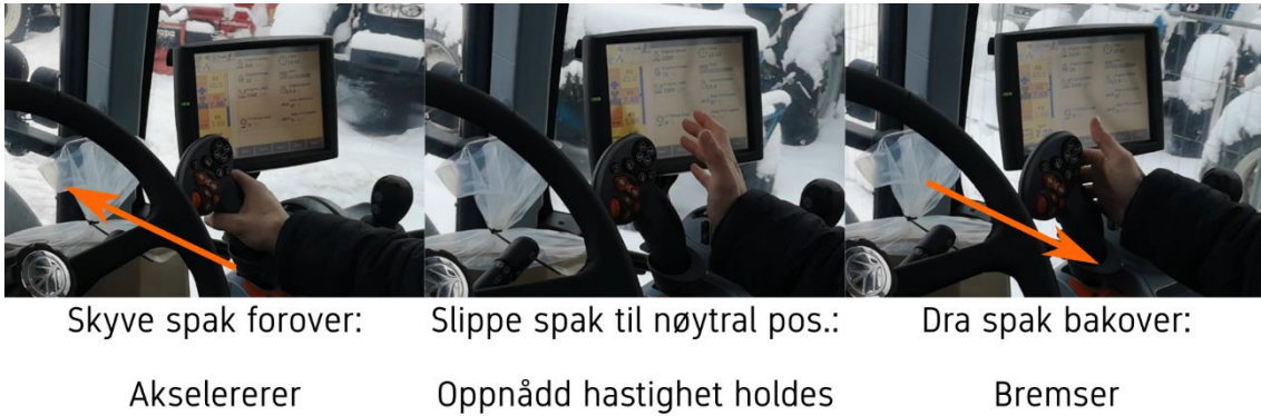
Figur 5: Hvordan man kjører framover. Foto: Monika S. Bakkehaug
