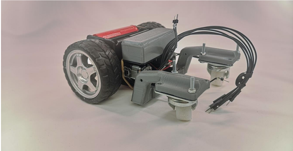
Figur 48: Ramme 3D-printet og komponentene montert. De er fortsatt ikke koblet til, så ledningene henger fortsatt løst utenfor.
