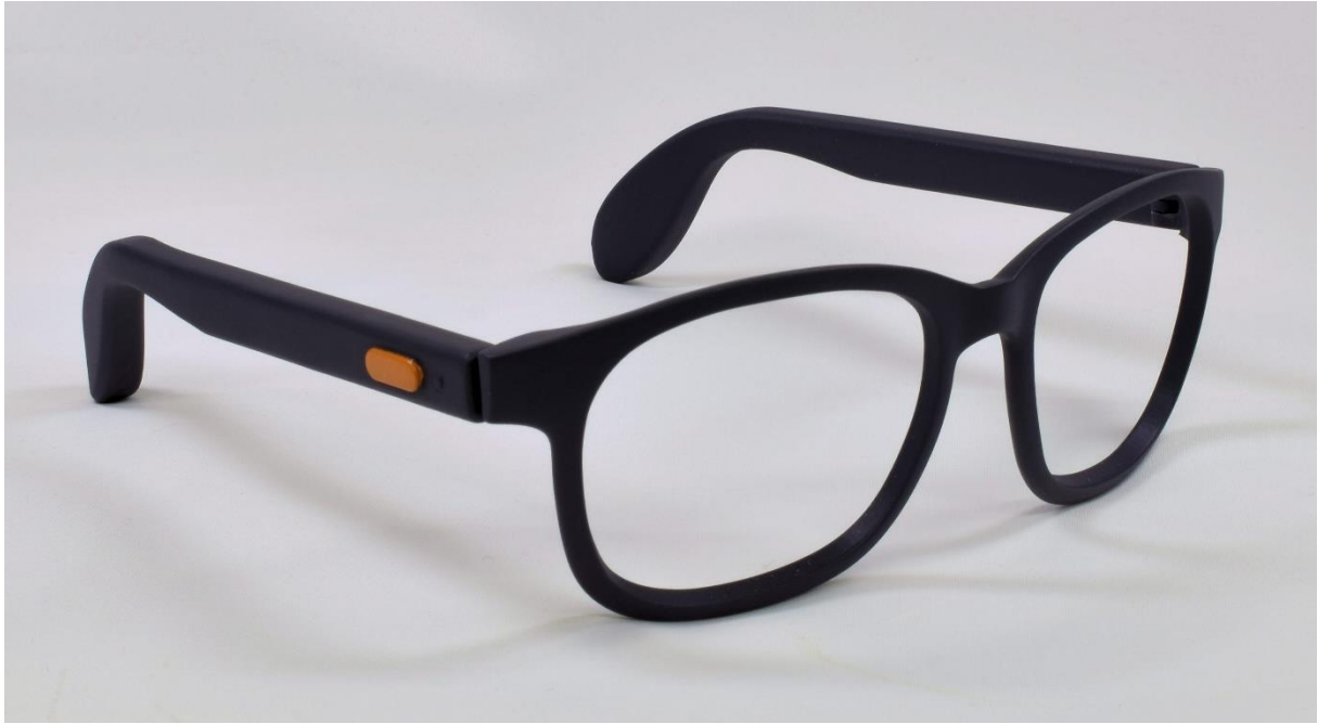
Figur 41: Utseenderiktig modell fra framside med aktiveringsknappen synlig.
