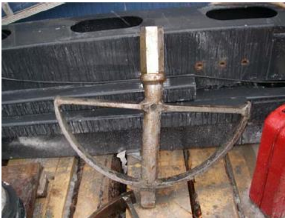
Bilde 3. 2 Halvsirkelligende visp (Norges Geotekniske Institutt 2011)
