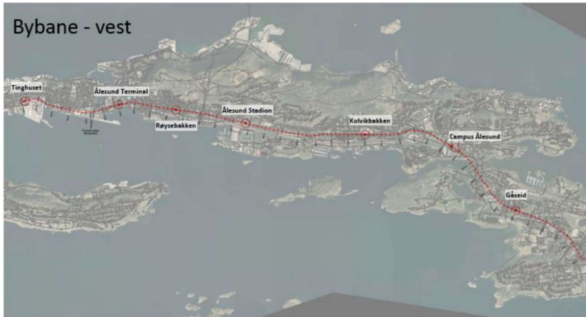
FIGUR 35: LINJEFØRING OG STOPP FOR COWI SIN LØSNING. ENDESTASJON VED HATLEBØEN VAR VALGT FOR Å GI MULIGHET FOR DEPOT OG INNFARTSPARKERING. (COWI, 2018)
