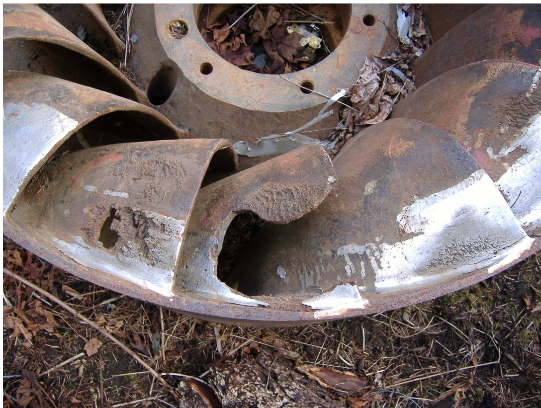
Figur 9 – Francisturbin med kavitasjonsskader
