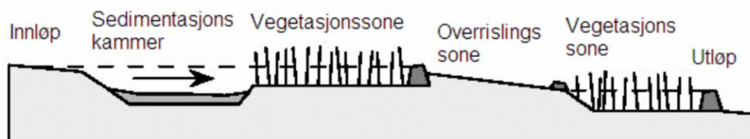
Figur 13. Vanlige komponenter i en fangdam (49)
