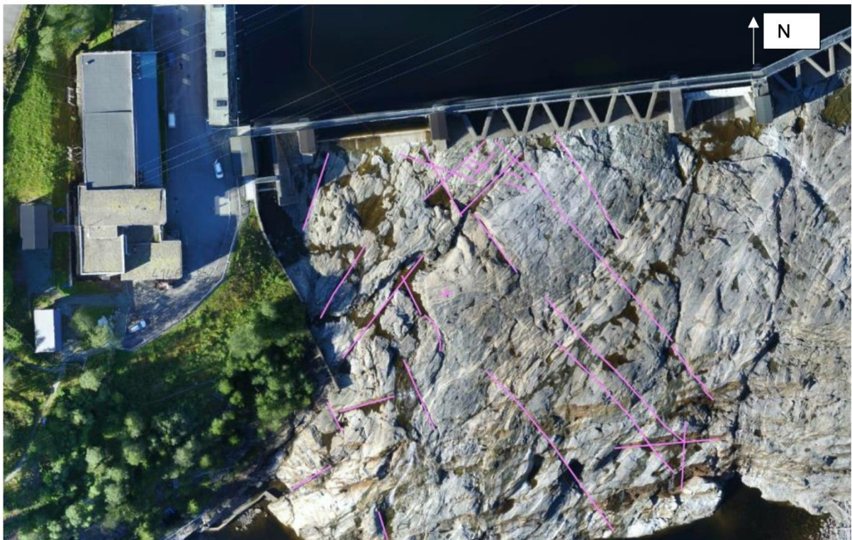
Figur 35: Flyfoto over nedstrøms overløp for kartlegging av foliasjonsretning. [3]
