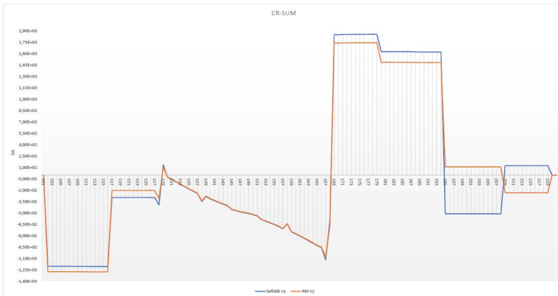
Figur 9 - 8: Skjærkraft Vx - Kryp pga. egenvekt
