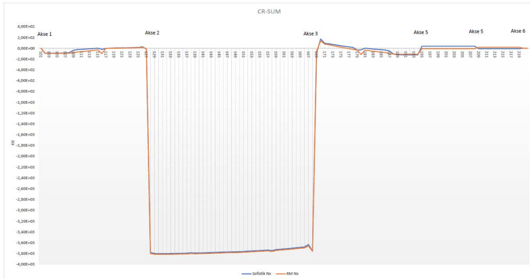
Figur 9 - 7: Normalkraft Nx - Kryp pga. egenvekt
