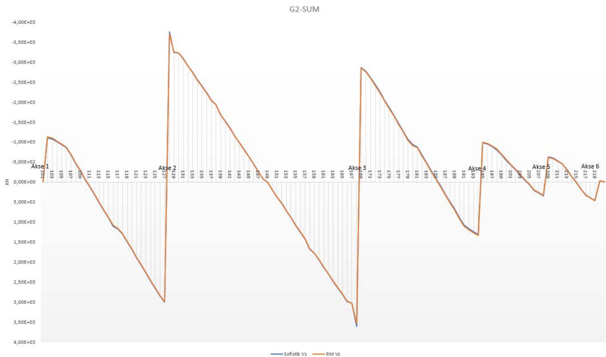
Figur 5: Skjærkraft Vz - Super-egenvekt
