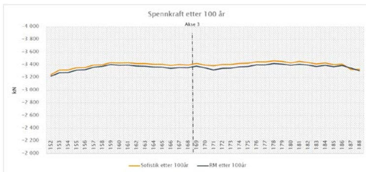
Figur 9 - 37: Spennkraft etter 100 år - kabel 113
