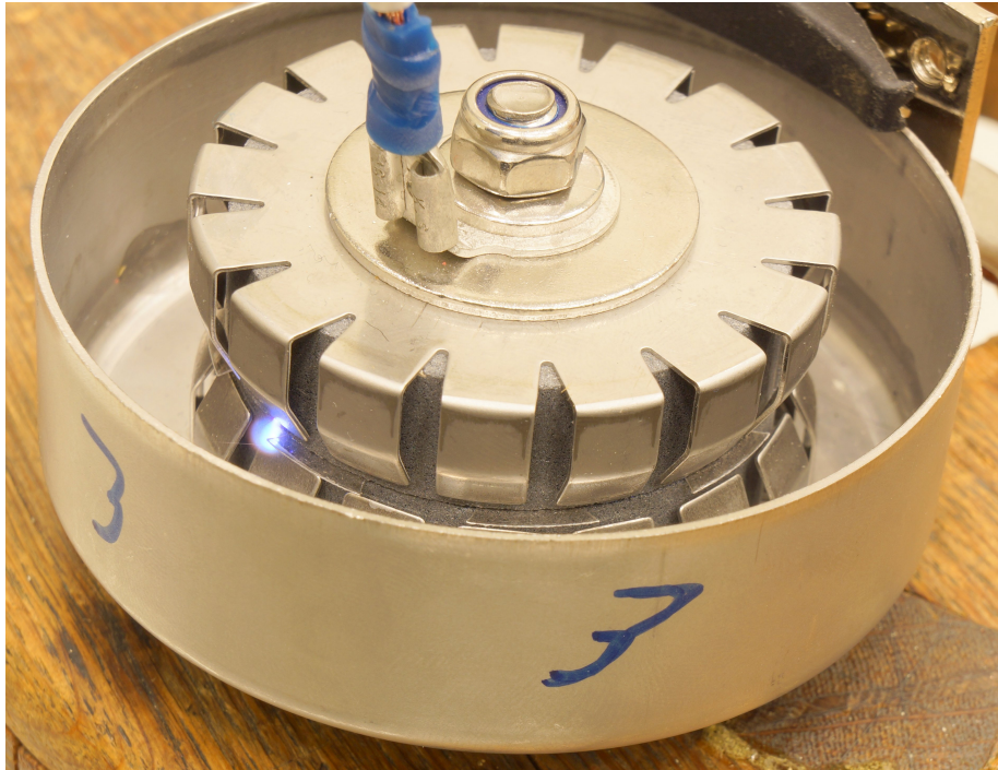
Figur 4.12: Overslag i ytre gap på testobjekt 3
