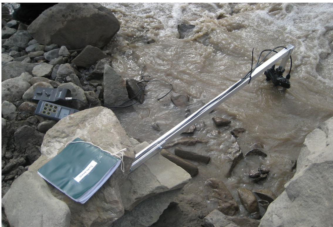
Figur 16: Trykksensor, konduktivitetmåler og turbidimeter i den glasiale elven. Foto: Marita Danielsen
