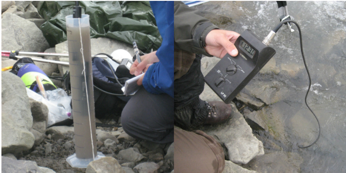
Figur 17: Måling av konduktivitetsendring etter tilsatt saltløsning i sylindren til venstre. Til høyre blir det gjort en måling av konduktiviteten i elven. Foto: Marita Danielsen
