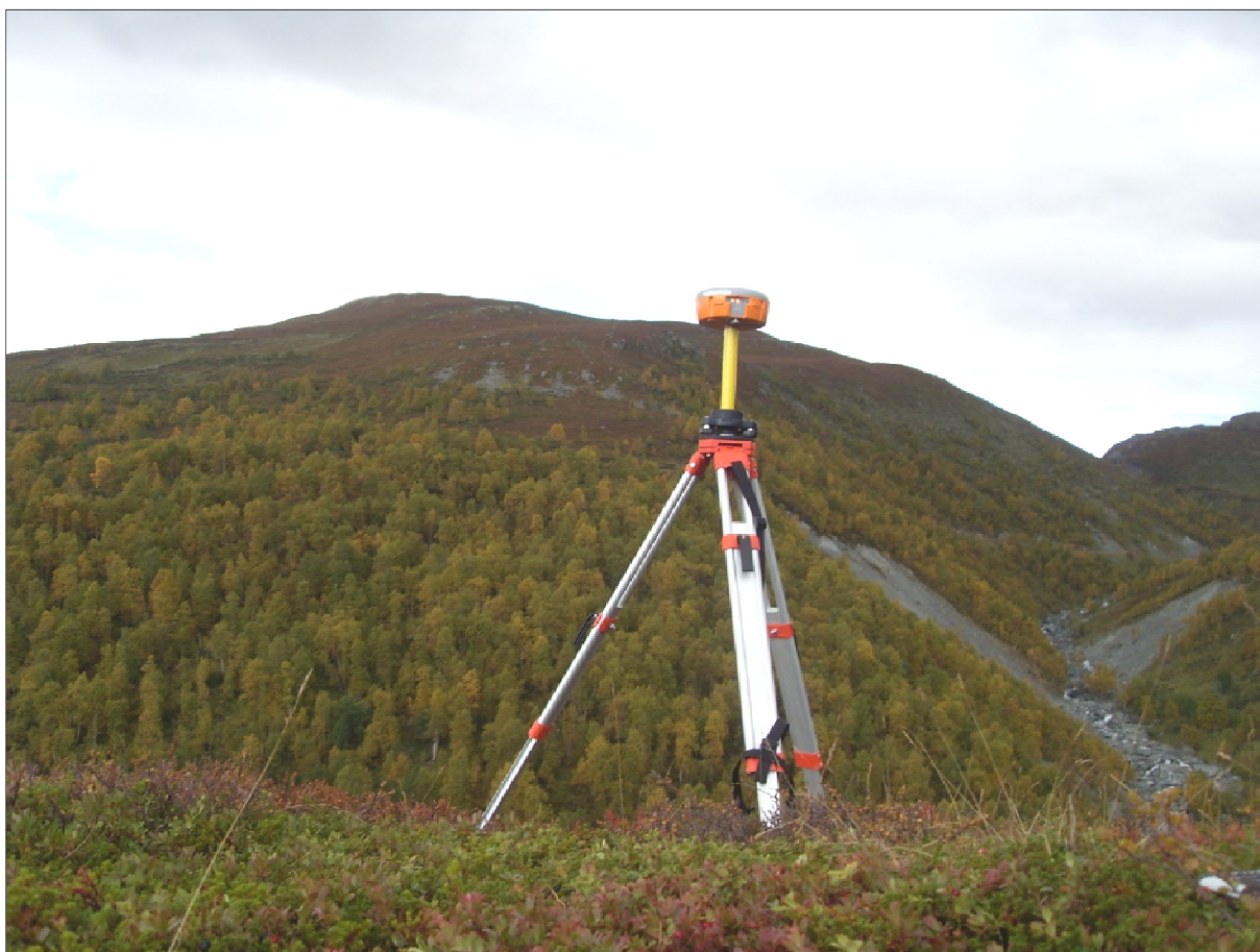
Figur 4: En av Geografisk Instituttets Altus APS-3-enheter satt opp som basestasjon i Vekve under feltarbeidet i september 2012.
