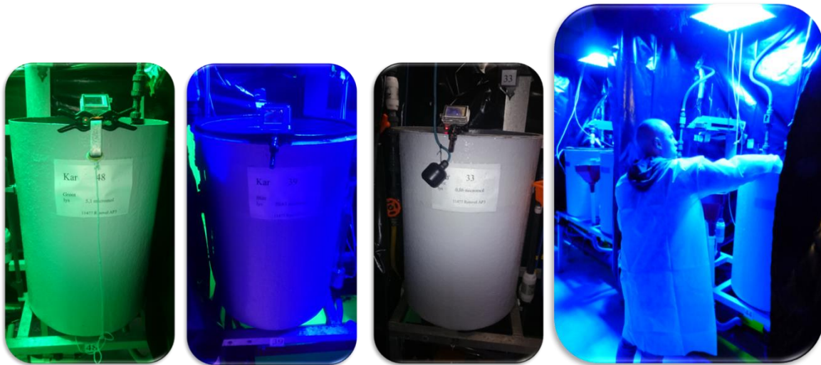
Figur 13 Forsøkskar med grønt (bølglengde 520nm), blått (bølglengde 450nm) eller fullspekter hvitt lys. Bildet til høyre viser hvordan lysene var plassert over karene, og hvordan kar med ulik behandling ble skilt ved hjelp av svarte plastvegger.
