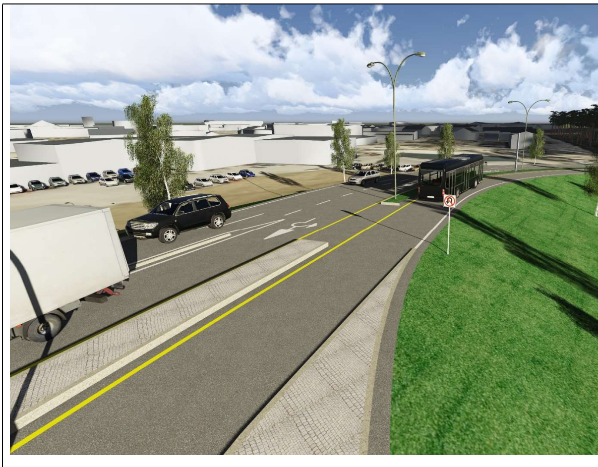
Figur 9: Turborundkjøring vest med rampe til/fra E6. Legg merke til prosjektert opphold i midtrabatt som sikrer muligheten for vinterdrift av turborundkjøringen. Lik løsning som observert i Geldrop Nederland, omtalt i masteroppgaven.
