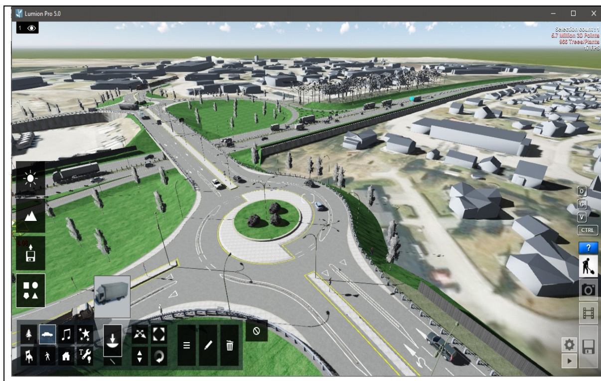
Figur 75: Skjermdump fra programvaren Lumion. Det prosjekterte topplanskryss med turborundkjøring er her importert fra Virtual Map.
