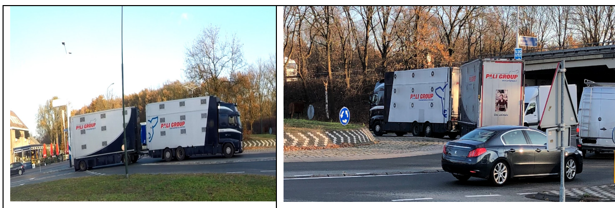
Figur 51: Tradisjonelt vogntog tar seg inn, gjennom og ut turborundkjøringen, uten å berøre «hinder». FOTO: Kjell-Amund Prestmo
