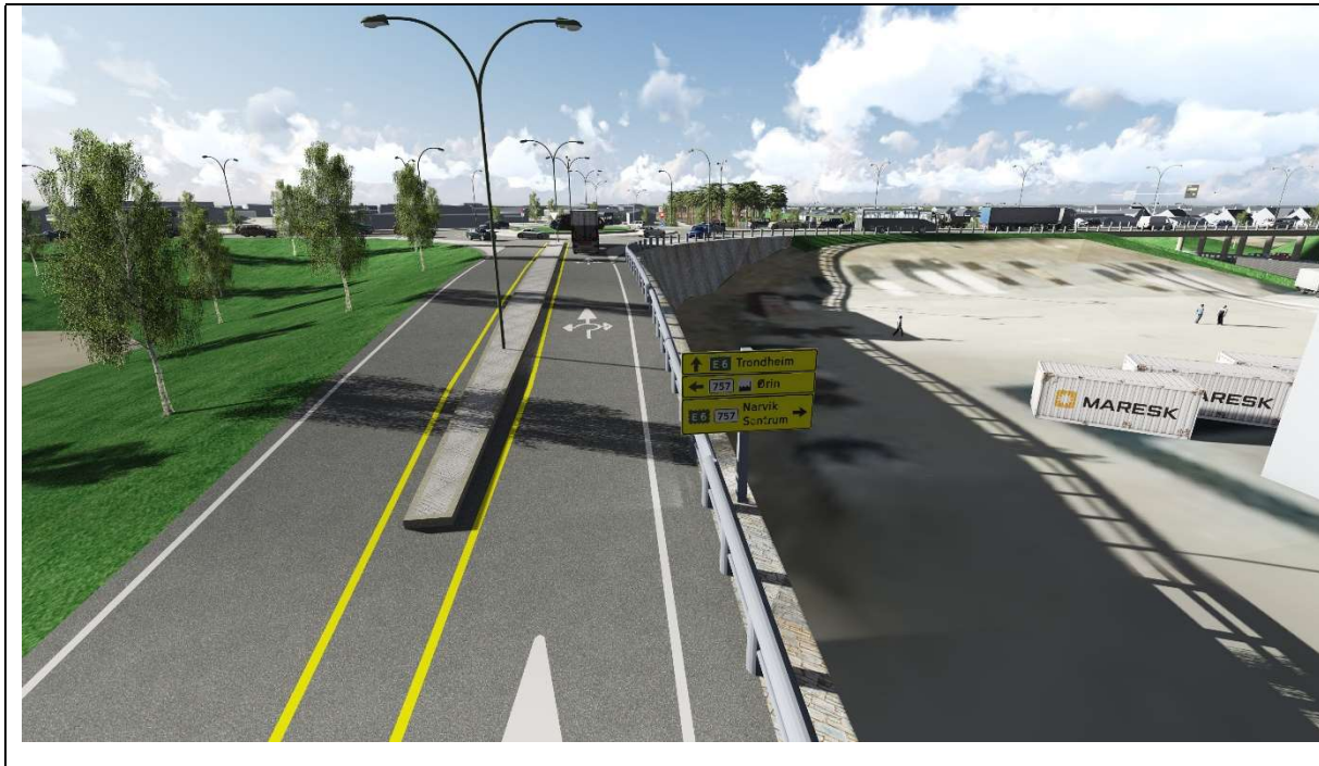
Figur 11: Turborundkjøring vest, arm til/fra Melkeveien. Forslag til mulig utforming, skilting og oppmerking for adkomst til turborundkjøring med kun et kjørefelt.
