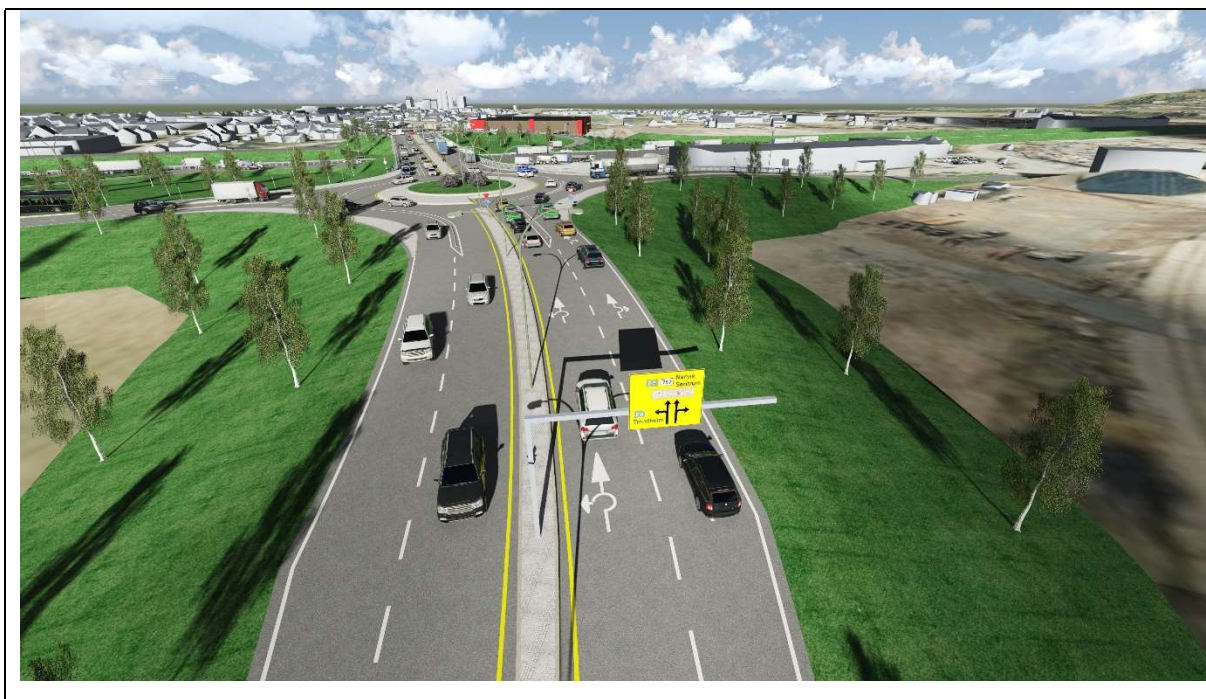
Figur 10: Turborundkjøring vest, arm til/fra industriområdet. Forslag til mulig utforming, skilting og oppmerking.
