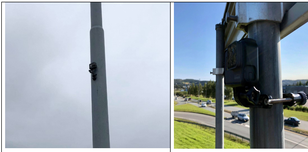
Figur 21: Til venstre GoPro 1 montert på lyktestolpe ved kryss vest. Til høyre GoPro 2 montert på trafikkskilt ved kryss øst. Foto: Kjell-Amund Prestmo
