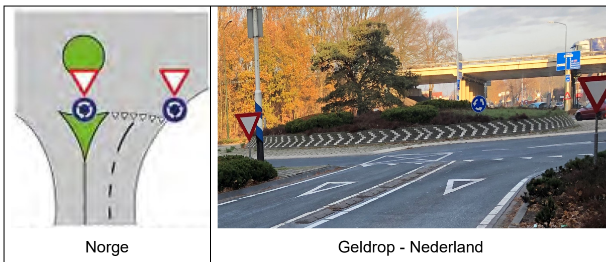
Figur 67: Skilting inn i rundkjøring i Norge og Skilting av turborundkjøring.
