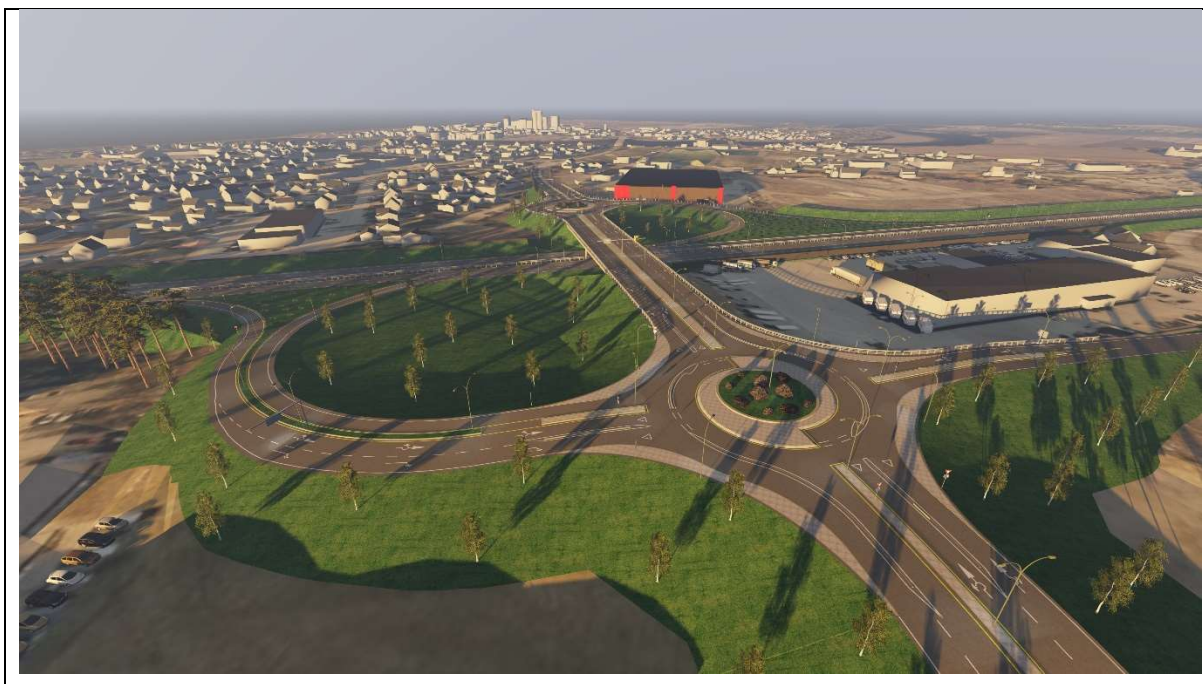
Figur 77: Visualisering av turborundkjøring i Havnekrysset, Verdal
