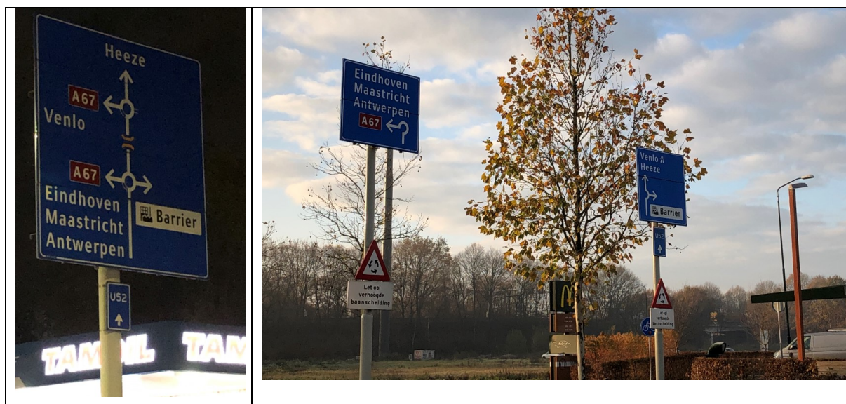
Figur 62: Figur til venstre viser eksempel på forvarsling av turborundkjøring i toplanskryss i Geldrop. Figur til venstre viser repetisjon av veivisningsskiltet. FOTO: Kjell-Amund Prestmo
