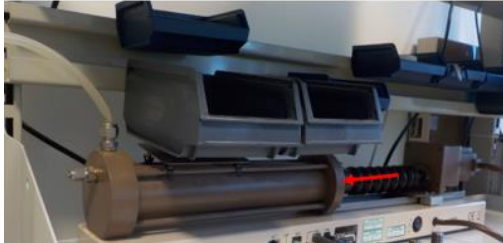
Figur 5 Datastyrt pumpe med innebygd sensor for styring av celletrykk. Pilen viser retning for pumpebevegelse ved trykkøkning i cellen.
