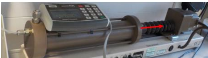
Figur 6 Pumpe for registrering av prøvens volumendring ut fra utpresset porevann. Pilen viser retningen for pumpebevegelse i konsolideringsfasen
