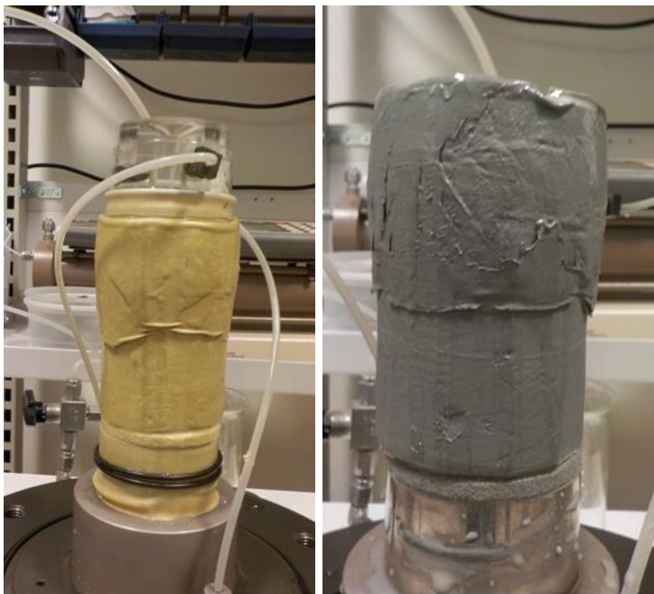
Figur 2 Prøve etter avsluttet aktivt udrenert forsøk
