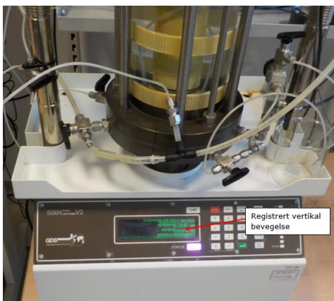
Figur 7 Ramme med innebygd trinnmotor og bevegelsessensor
