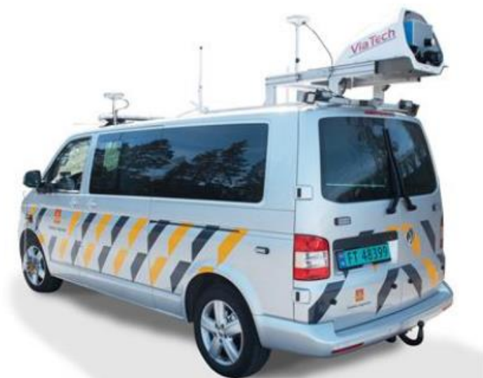
Figur 21 . ViaPPS målebil for spor ,ujevnhet ,og tverrfall (foto:Viatech )
