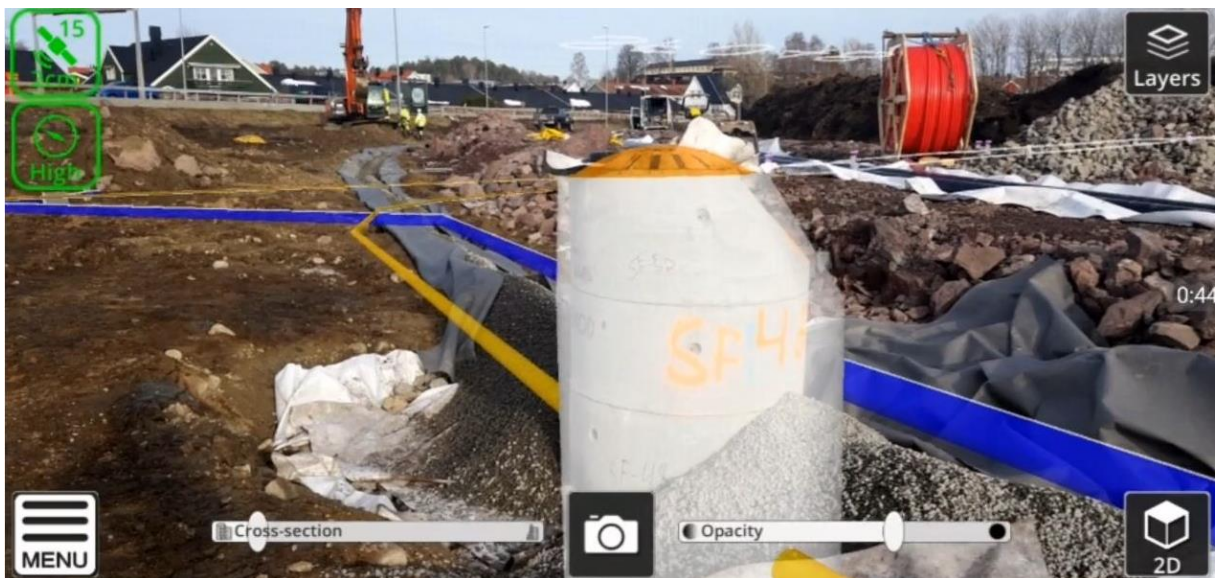
Figur 22 viser en 3D-fagmodell VA og en VA-kum som er bygd (Kilde: (Raunholm, 2019e))
