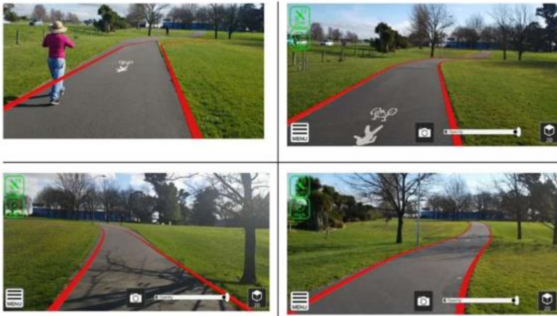
Figur 13: viser "drifting" av 3D-modell problemer med Trimble Sitevision (Kilde: (Sitech, 2019))
