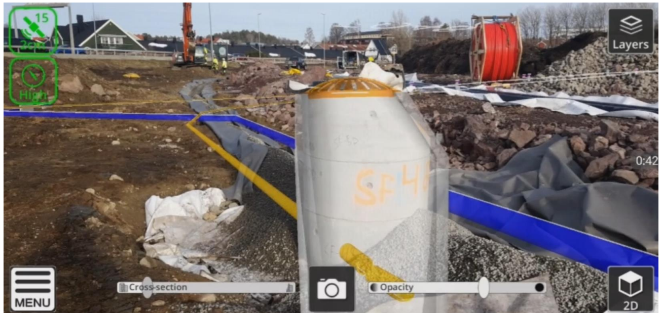
Figur 15 viser et skjermdump fra AR-systemet Sitevision ute på byggeplass (Kilde: (Raunholm, 2019a))
