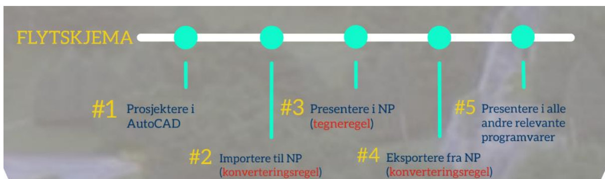
Figur 32 - Flytskjema for bruk av prosjektregler i Novapoint
