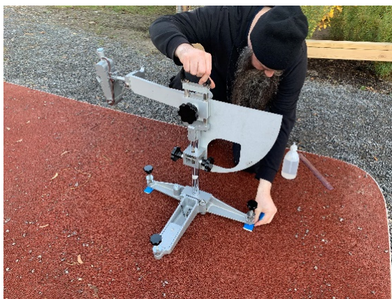
Figur 6.4: Utfordring 2. Pendelapparatet må understøttes for å ikke synke i det myke belegget.
