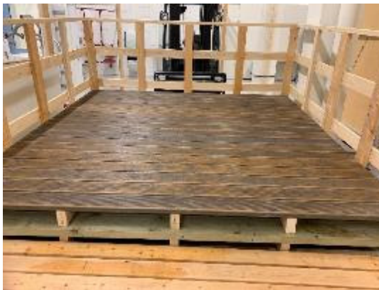
Figur 7.3: Impregnert treverk med riller
