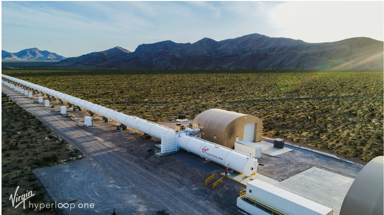
Figur 2: Devloop er en 500 meter lang test-trase bygget av Virgin hyperloop one i Nevada, USA (Hyperloop one media gallery, n.d.).
