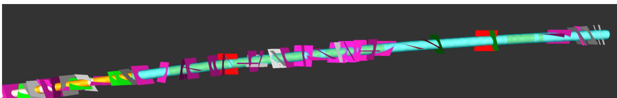
Figur 7.28: Eksempel på OTV-hull. Det lyseblå filteret som er drapert rundt borhullet viser at det er registrert vann her. Bak kan bergartene skimtes. Planene representerer kartlagte sprekker. Bildet er laget i NavisWorks.
