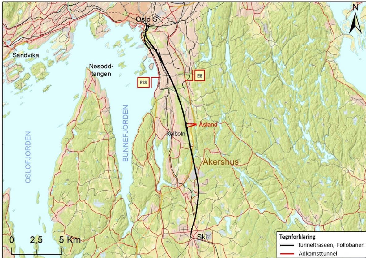
Figur 1.1: Kart over Follobanen som går mellom Oslo S og Ski. Den svarte linjen viser tunneltraseen og den røde linjen viser anleggsområdet Åsland. Kartet er laget i ArcMap 10.5 med grunnlagskart fra NGU i koordinatsystem WGS 1984 UTM sone 32N.
