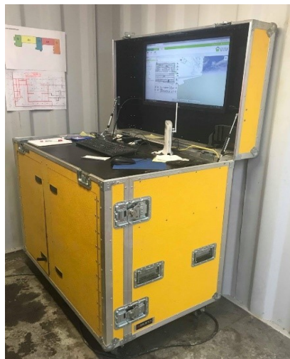
Figur 11 – BIM-kiosk på prosjekt Nærbyen
