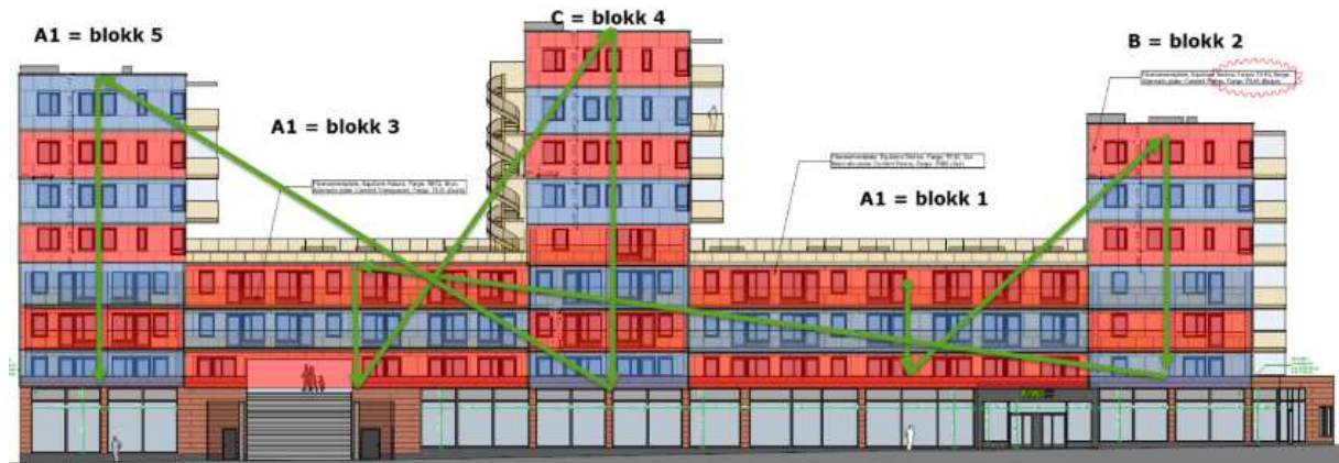
Figur 17 - Eksempel på etasjevis inndeling i og sekvensering av kontrollområder i et leilighetsbygg (Veidekke, 2018)
