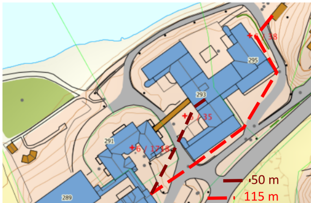
Figur 8.3: Mulige rørforbindelser mellom eldre del og energisentral Fra energisentral er det ca. 115 m og fra teknisk rom ca. 50 m til inngangsparti i eldre del.
