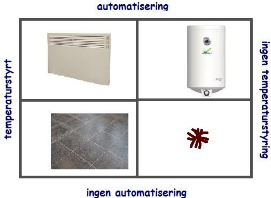
Figur 8.1: Anbefalt funksjonalitet for integrerte enheter Varmtvannstanken bør kunne styres automatisk, gulvvarme bør kunne temperaturstyres mens panelovner bør både kunne temperaturstyres og automatiseres.
