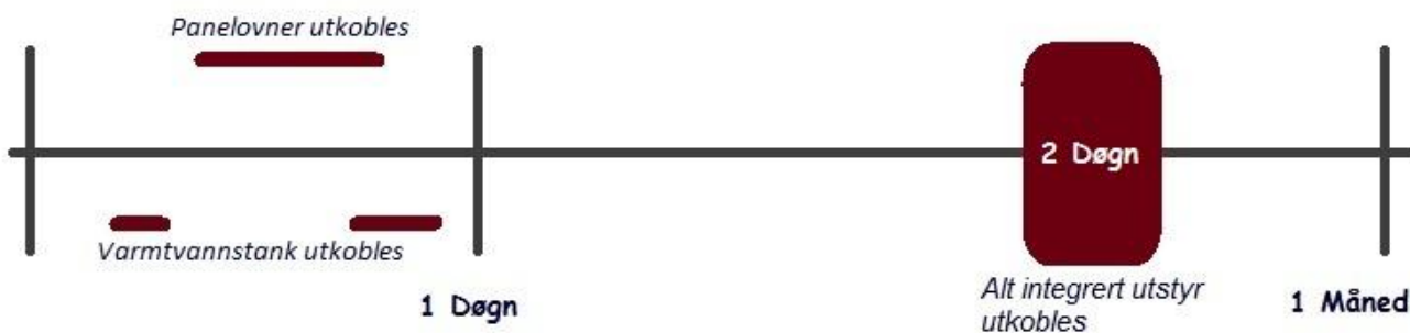
Figur 10.2: Optimalt bruksmønster: Panelovner utkobles 8 timer i døgnet, varmtvannstank utkobles 6 timer i døgnet fordelt på 2 perioder, alt utstyr inkludert gulvvarme kobles ut 2 døgn hver tredje helg. (reise/hytte/fritidsbolig).
