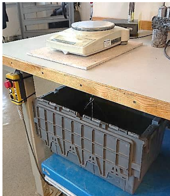
Figur 10 - Innretning for måling av prøvevolum
