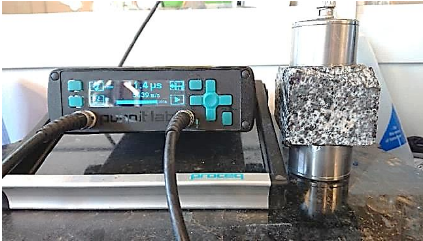
Figur 9 - Apparat for måling av lydshastigheter
