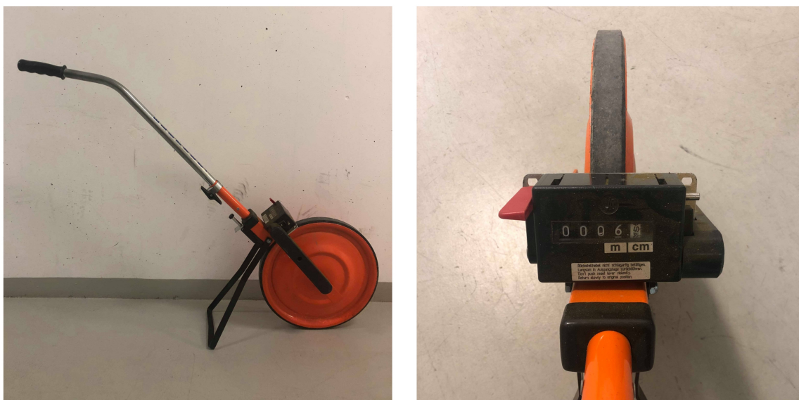
Figur 1*: (a) Måleutstyr for generell observasjon. (b) Målevindu. (Foto: Privat)
