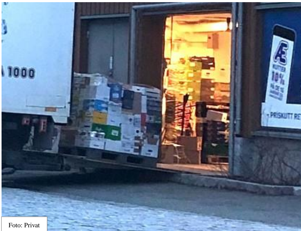
(2) Løftebrettet senkes direkte inn i luken og varer transporteres inn i varemottaket.
