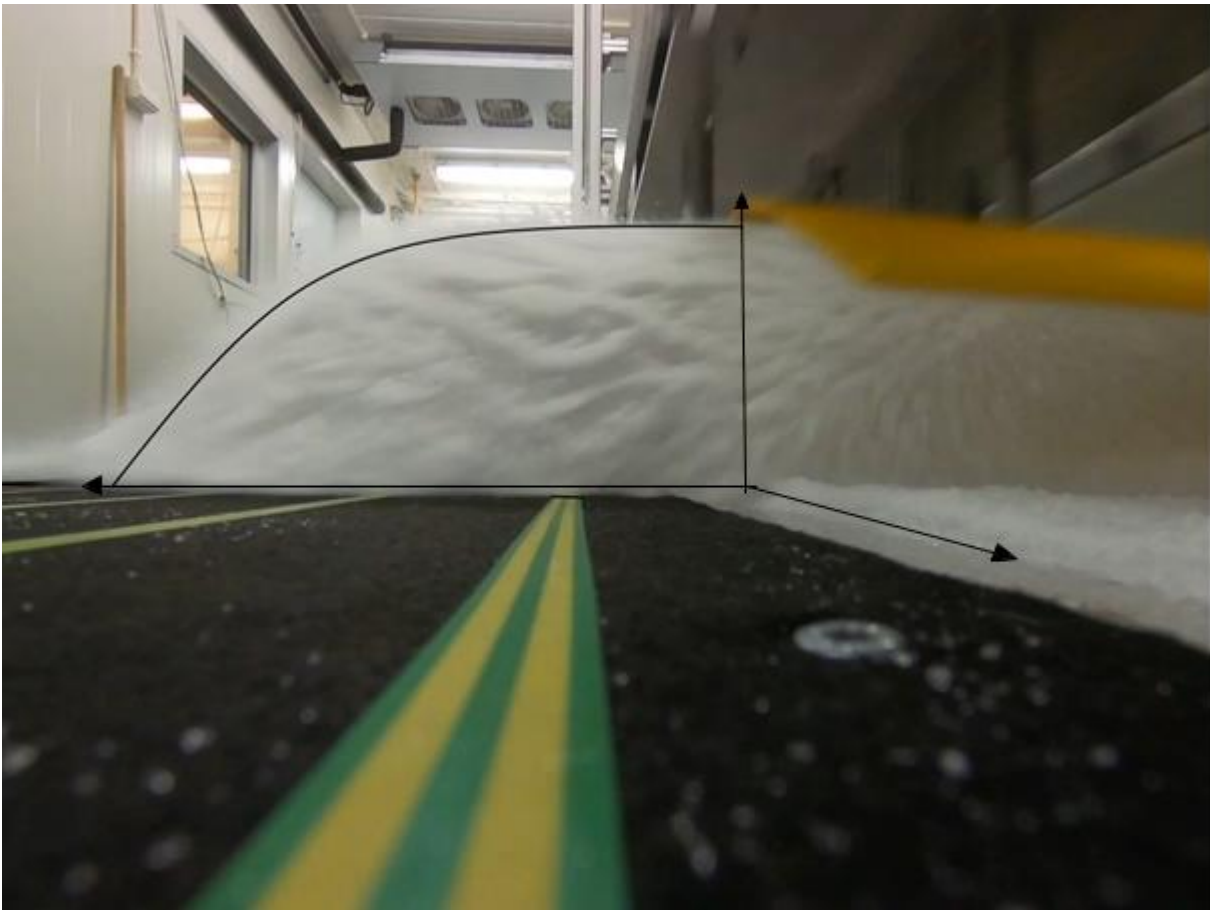
Figur 10: Utkastprofil og koordinatsystem sett fra GoPro-kameraL1.
