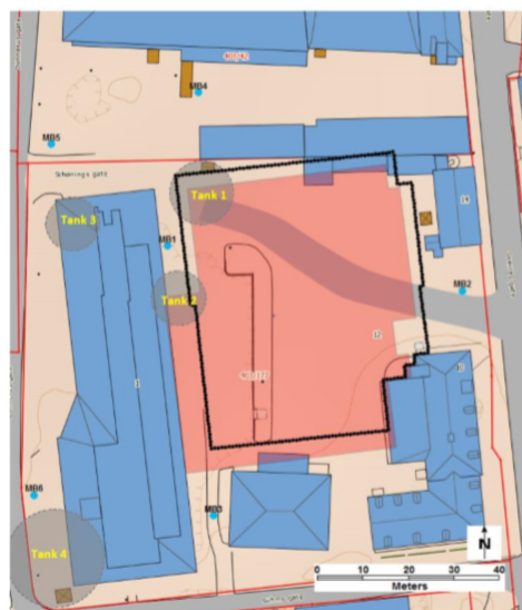
Figur 3.6: Oversikt over gassverktomta, på Kalvskinnet i Trondheim. Sort linje viser spuntvegg. De blå punktene viser grunnvannsbrønnene MB1-MB6. De grå sirklene er lokalisering av tidligere tanker fra den tiden det var gassverk på eiendommen (Eggen, 2016)
