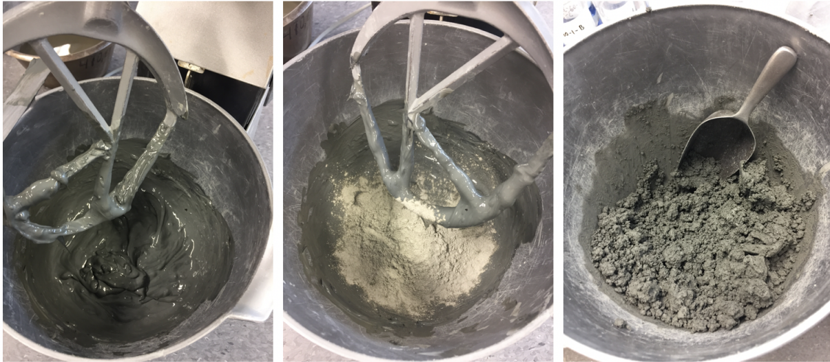
Figur 3.2: Innblanding av bindemiddel. Nedbrutt leire, tilsetning av bindemiddel og leire etter innblanding.
