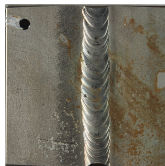
(d) Back side of coated sample.
