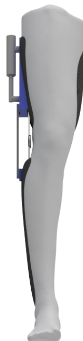
Figur 5.11: Alternativ 2: Innfestning på lårkomponent med forbindelse til leggkomponent.
