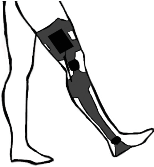
Figur 3.28: Konsept 5: KAFO med hydraulisk lås.
