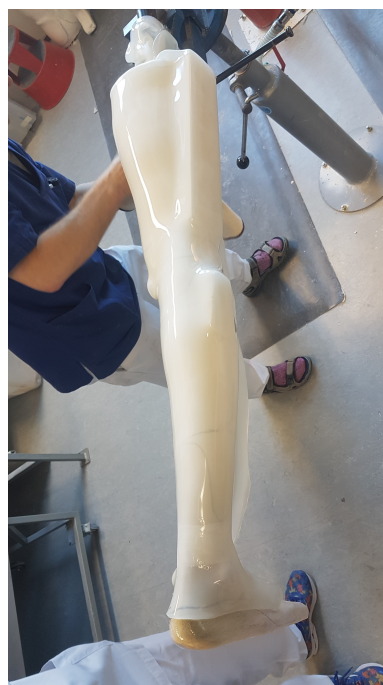
Figur 5.30: Trekking av plastplate på skummodell.
