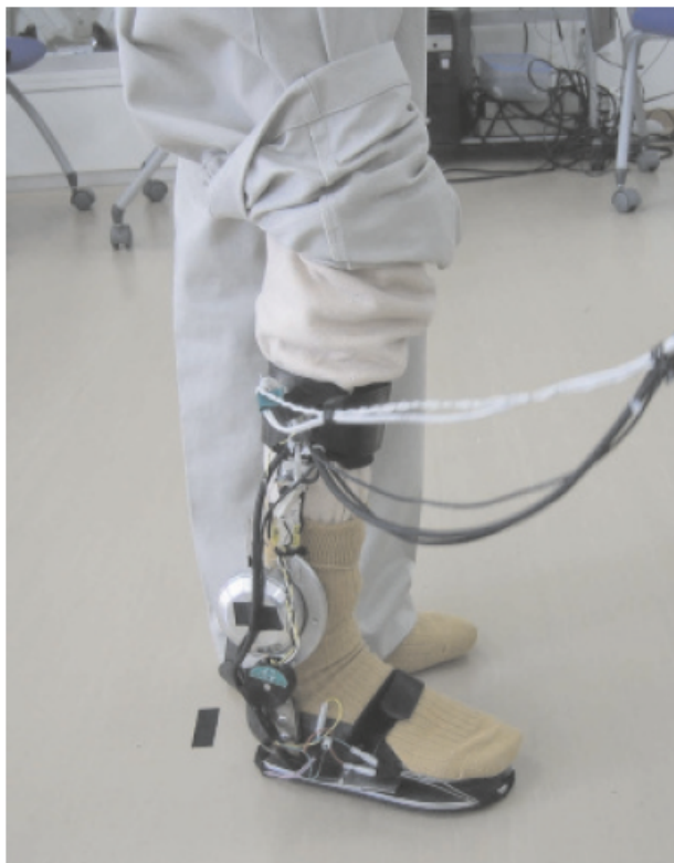
Figur 7.1: Ankek-Fot ortose basert på magnetoreologiske brems [7].
