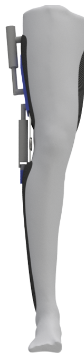
Figur 5.13: Alternativ 3: Innfestning på lårkomponent med forbindelse til leggkomponent.
