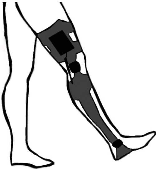
Figur 3.26: Konsept 4: KAFO med hydraulisk lås
