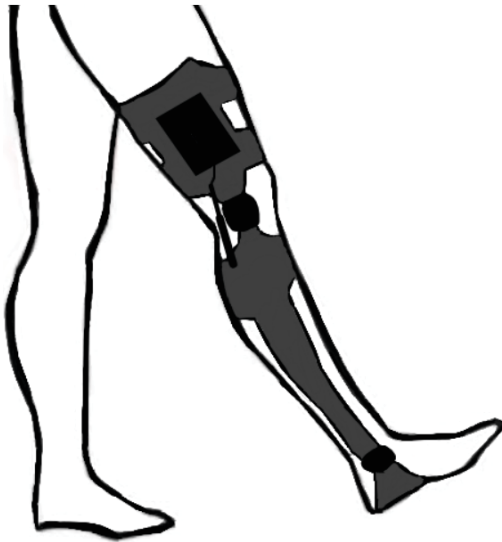
Figur 3.24: Konsept 3: KAFO med magnetoreologisk demper
