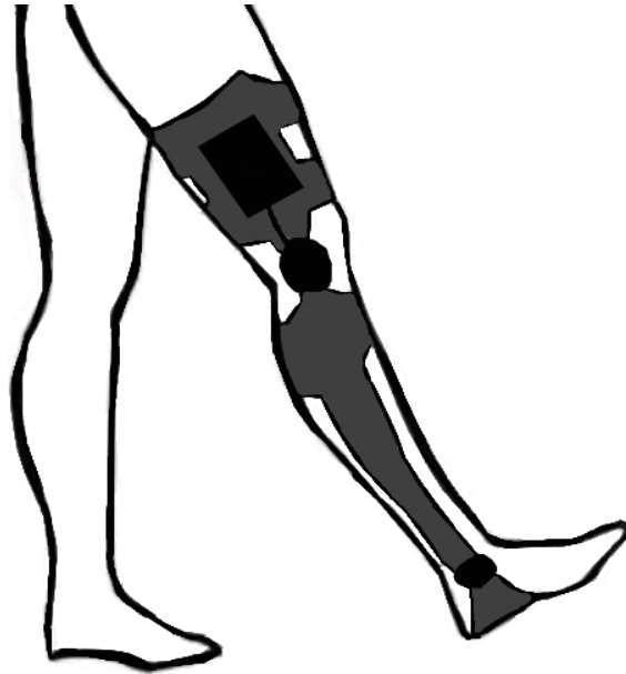
Figur 3.19: Konsept 2: KAFO med elektromagnetiskbrens.
