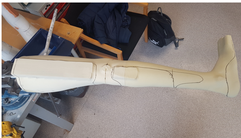
Figur 5.28: Opptegning av design på skummodell.
