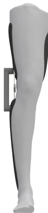
Figur 5.9: Alternativ 1: Innfestning mellom lår- og leggkomponent.
