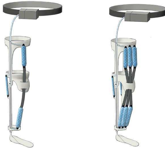
Figur 3.2: Konsepttegning av dynamisk KAFO med McKibben-muskler utviklet i tidligere arbeid [2]
