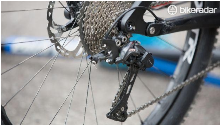
Figur 32: Girskiftet på bakhjulet for et avhoppsgir[32]
