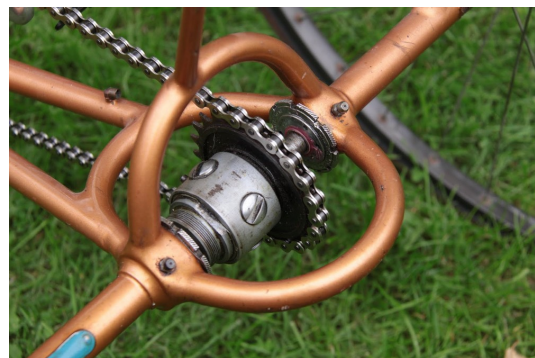
Figur 17: Eksempel av differensial på en trehjulssykkel hvor kjedet blir brukt til å drive kronhjulet ([25]).
