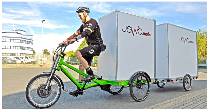
Figur 18: Bilde av en Radkutsche Musketier sykkel med en ekstra tilhenger tilkoblet. Dette designet ble valgt ut av transportavdelingen fra en samling av eksempler på forskjellige designløsninger for vare sykler.
