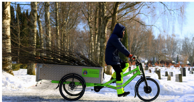
Figur 44: Designet transportavdelingen selv valgte fra en gruppe eksempler[37]. Denne versjonen av Muskieter sykkelen er utrustet med et lasteplan som er 150cm langt.
