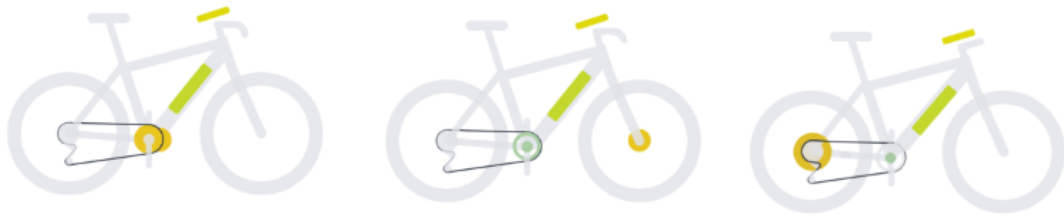
Figur 9: Fra venstre: krankmotor, navmotor i fronthjul og navmotor i bakhjul [17]
