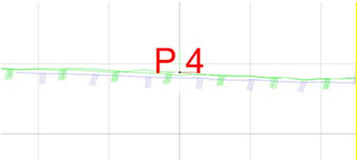
Figur 33: Denne tverrprofilen viser TIN-modellen (markert med blå) og punktskymmodellene til eBee og Phantom. TIN-modellen ligger hele veien lavere enn hva punktskyene gjør.
