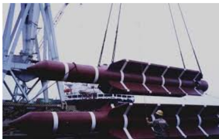
(b) Drop anchors (Bastos de Araujo et al., 2004)
