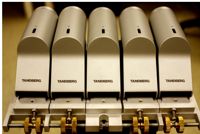
Figur 7.4: Spesiallaget kamerafeste for nøyaktig kalibrering av kameraene
