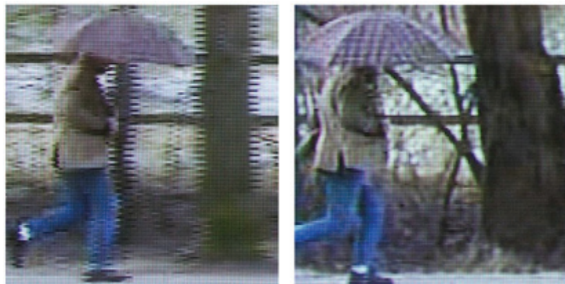
Figur 2.10: Interlaced (til venstre) og progressiv (til høyre) skanning
