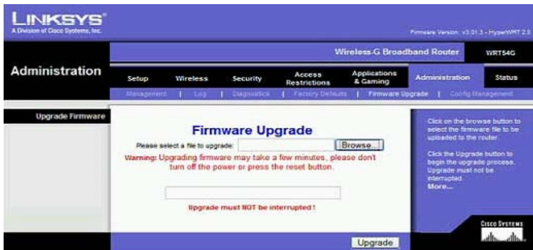
Figur 11 Konsoll før flashing av firmware i en original WRT54GL ruter.
