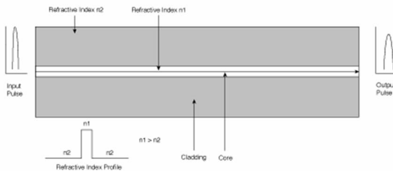
Figur 4.20: Singlemodus optisk fiber
