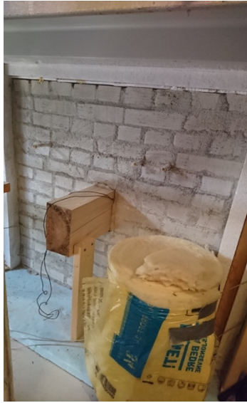
Figur 12: Viser innvendig/varm side av klimasimulatoren og hvordan trebjelkeenden er satt inn i veggfeltene og hvordan bjelkesensorene er montert i bjelkeenden. Bilde til høyre viser også et veggfelt hvor isolasjonsplater av fenolskum er montert. Bildene under viser veggfeltene ferdig montert med gipsplate og tetting rundt bjelkeenden. Bildet nederst til venstre er rørene hvor noen av temperatur- og RF sensorene ligger.
