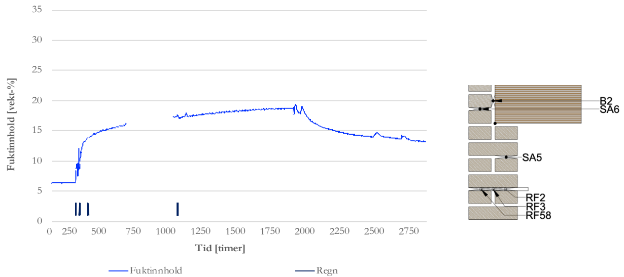
Figur 22: viser fuktinnholdet i bjelkeenden i veggfelt 2. 16,2 vekt-% tilsvarer en RF= 80% og 32 vekt-% tilsvarer RF =100%
