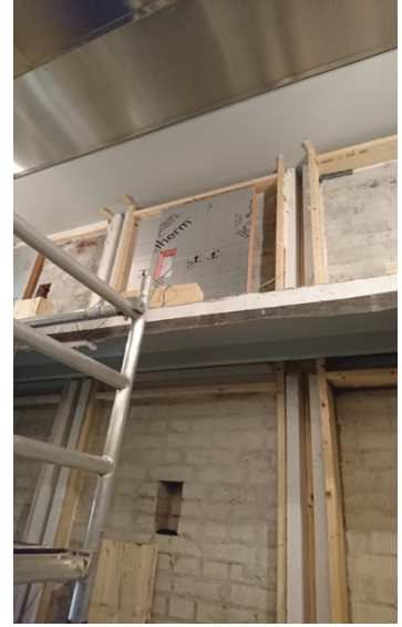
Figur 12: Viser innvendig/varm side av klimasimulatoren og hvordan trebjelkeenden er satt inn i veggfeltene og hvordan bjelkesensorene er montert i bjelkeenden. Bilde til høyre viser også et veggfelt hvor isolasjonsplater av fenolskum er montert. Bildene under viser veggfeltene ferdig montert med gipsplate og tetting rundt bjelkeenden. Bildet nederst til venstre er rørene hvor noen av temperatur- og RF sensorene ligger.
