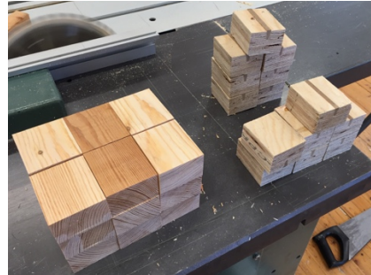
Figur 17 - Både LVL og furu prøvene ble kuttet opp i like store deler.
