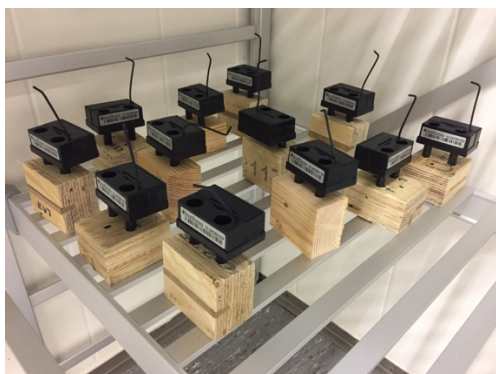
Figur 21 - Sensorene plassert i fuktlaboratoriet.
