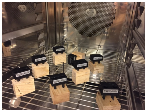
Figur 22 - Sensorene plassert i klimaskapet på en rist.
