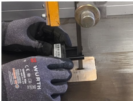
Figur 18 - Plastdelen ble kuttet med stikksag
