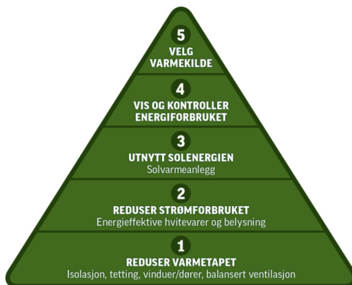
Figur 2.17: Kyotopyramiden viser en metodikk på energieffektivt design av nye og eksisterende boliger. Metoden går ut på å starte nederst med å redusere varmetapet, deretter designe videre etter punktene ovenfor og avslutte med å velge varmekilde (Bolig Enøk, 2019).
