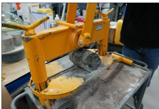
Figur 4-18: SINTEF-maskin for splitting av kjernedeler.
