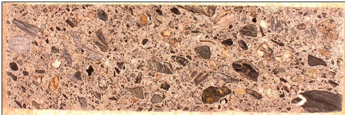
Figur 5-38: Planslipt overflate av sjikt 0 – 300 mm
