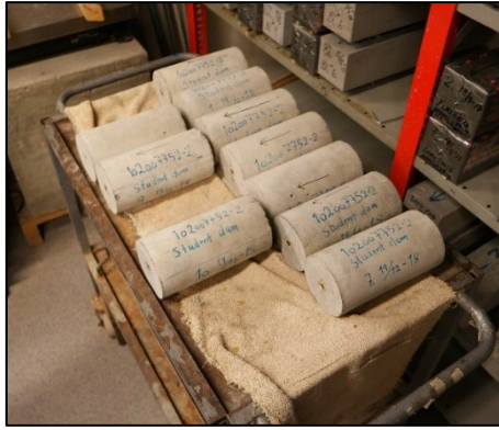
Figur 4-6: Kjerner klargjort for ekspansjonsmåling
