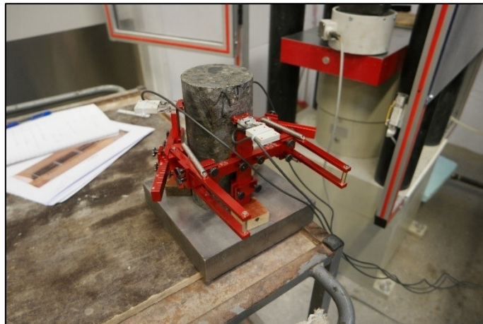
Figur 4-12: Planslipt prøvestykke med givarar montert
