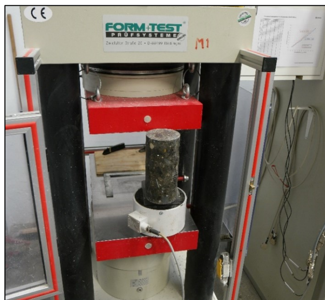
Figur 4-10: Prøvestykke klart for påføring av trykklast i FormTest Alpha 4/B-62
