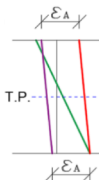
Figur 2-20: Resulterende tøyingstilstand frå eigenvekt + alkalireaksjon (Stemland et al., 2016)
