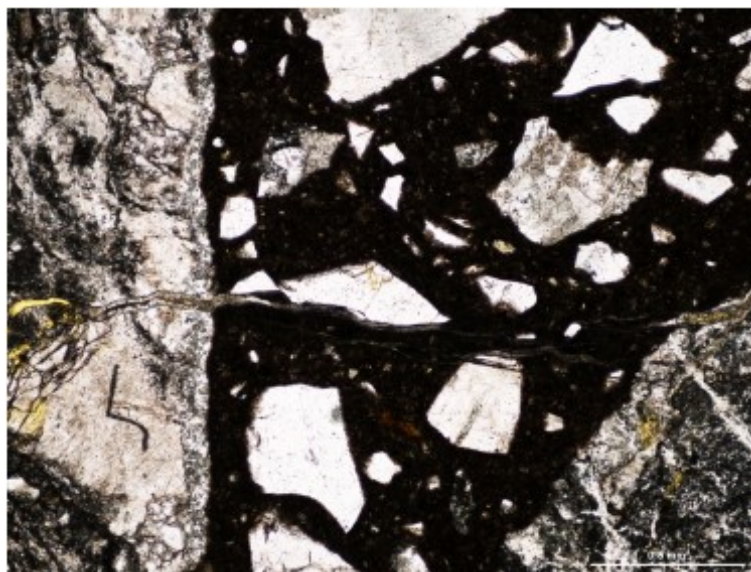
Figur 2-10: Alkali-silika-gel i sprekk mellom kataklistiske partiklar (Lindgård, 2013)
