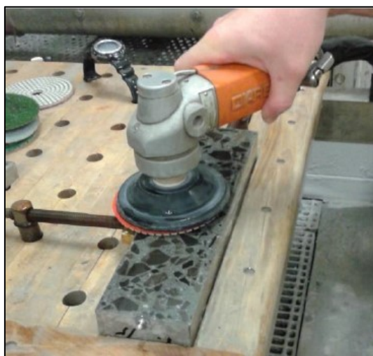
Figur 4-23: Våtslipemaskin nytta for polering av DRI prøvar (vedlegg 19)
