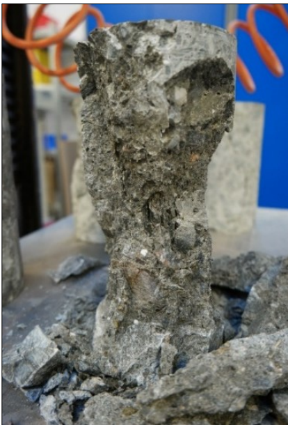
Figur 4-16: Prøvestykke gått til brudd. Synleg alkaligel fleire plassar.
