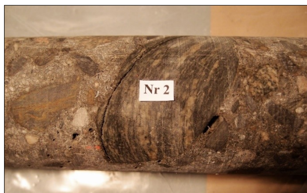
Figur 5-2: Riss i randsone av tilslag i prøve nr. 2
