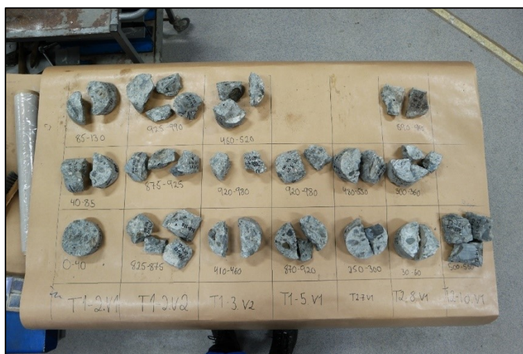
Figur 4-21. Oversikt over prøvestykke til in-situ vassinnhald og DCS.
