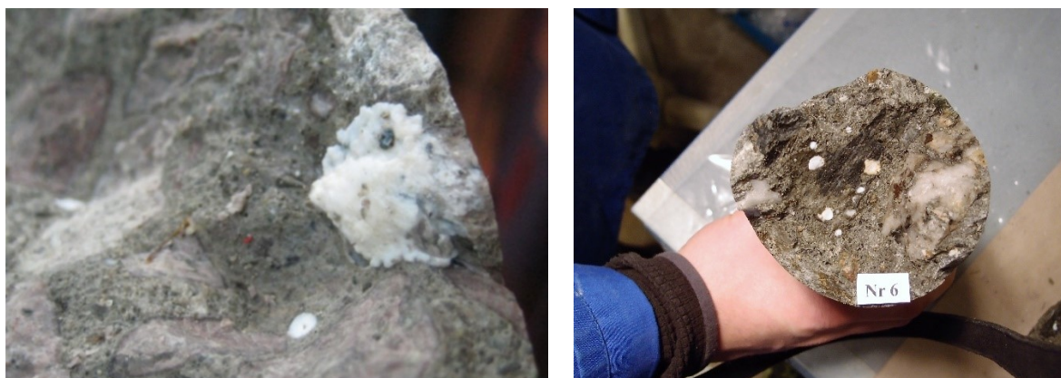
Figur 2-9: Alkali-silika gel. Til venstre: Alkali-Silika gel i luftboble og ved reagert steinpartikkel. Til høgre: Kvit utfelling (gel) i kjerneprøve
