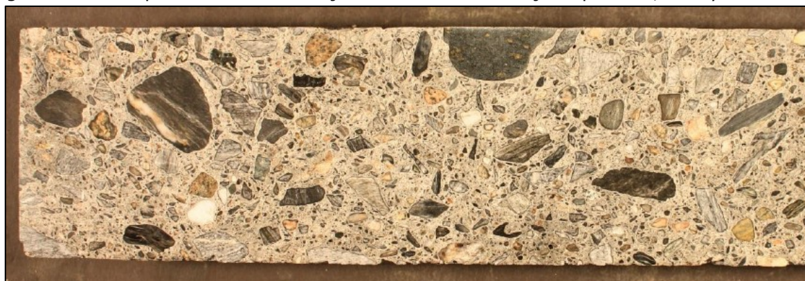
Figur 5-44: Planslipt overflate av sjikt 470 – 670 mm
