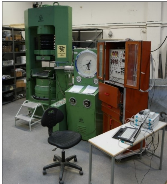
Figur 4-17: Losenhausen 5000 kN. Oppsett for arbeidsdiagram
