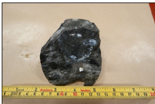
Figur 4-19: Skive med alkaligel i tilslagsoverflate og i pore
