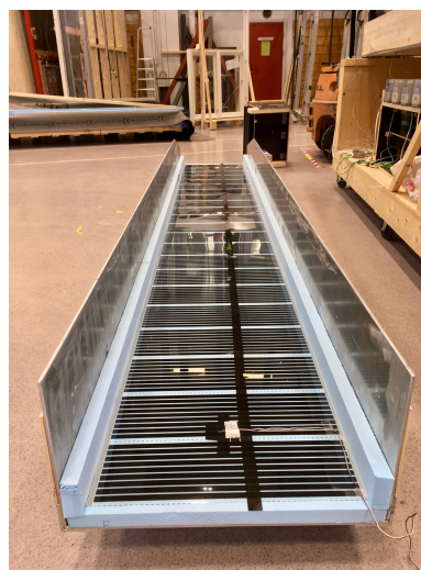
(b) Aluminiumslokk sett fra innsiden der varmemefolie og XPS er montert.
