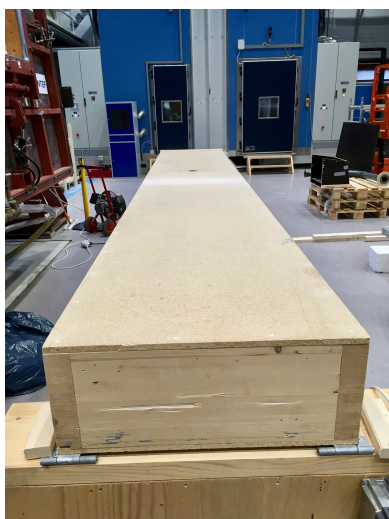
(a) Modellens underdel. Sponplaten øverst utgjør spaltens bunnoverflate
