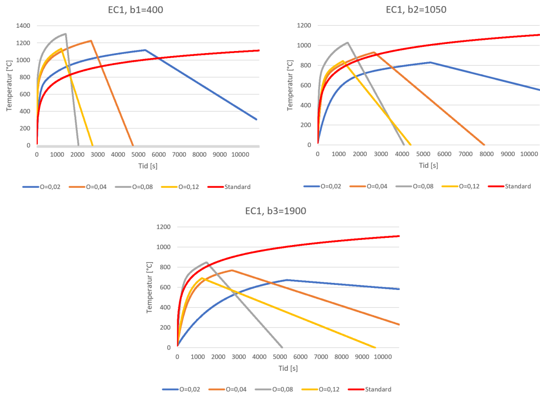
Figur 5.1: Parametriske temperaturtid-kurver fra EC1 ved varierende b -verdier ( b_1=400 , b_2=1050 og b_3=1900 ) og åpningsfaktorer (blå= 0,02 , oransje= 0,04 , grå= 0,08 og gul= 0,12 ). Samtlige kurver har en brannlast på 750 \text{ MJ/m}^2 \text{ gulvareal} . Den røde kurven er standard temperatur-tidkurven fra ISO 834.
