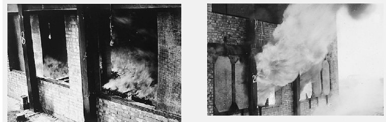
Figur 3.4: brenselstyrt brann (venstre) sammenliknet med ventilasjonsstyrt brann (høyre). Ved brenselstyrt er nok tilluft til at gassene kan brenne i rommet, mens ved ventilasjonsstyrt er det ikke nok tilluft, og eksterne flammer oppstår, slik som til høyre. Hentet fra Drysdale (2011).
