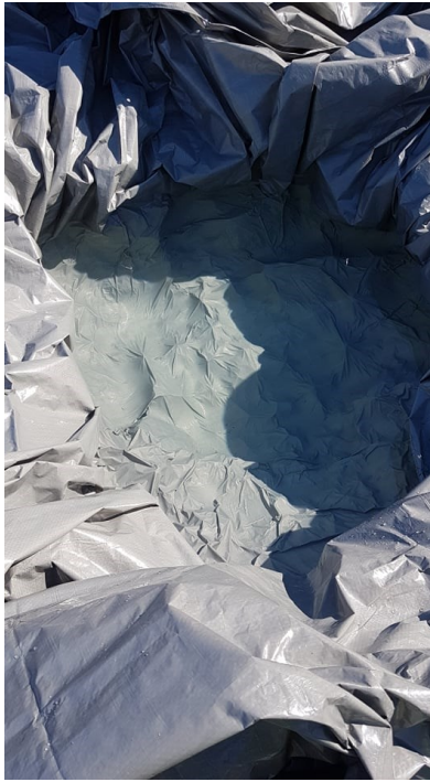
Figur 47: Presenning med vann i testhull 1
