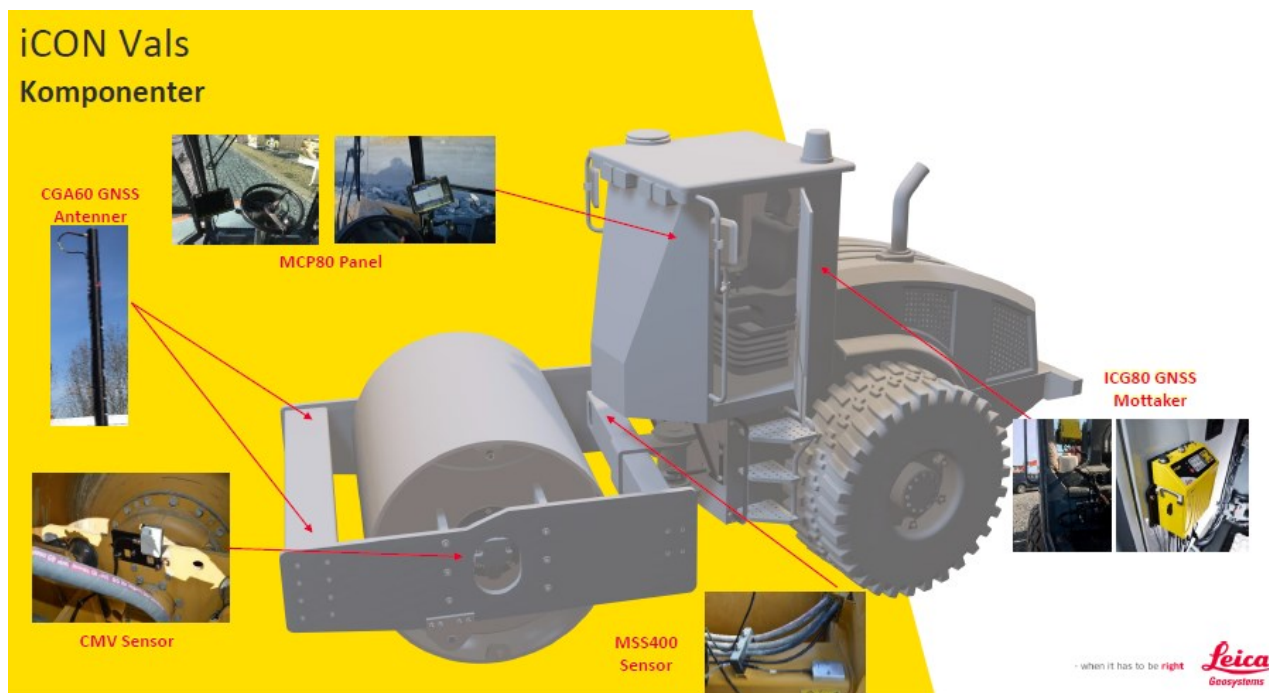
Figur 32: Komponenter i iCON systemet (powerpoint presentasjon fra Fredrik Berentsen i Leica Geosystems)
