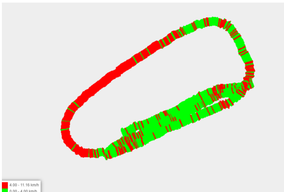
Figur 54: Valsemønstre i forhold til hastighet
